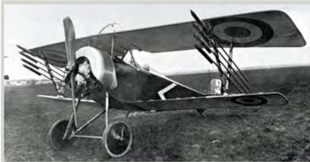
L'avion de chasse Nieuport, équipé de 8 fusées-torpilles.
